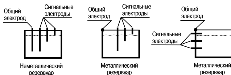
Рисунок 6.4 – Примеры установки кондуктометрических зондов
