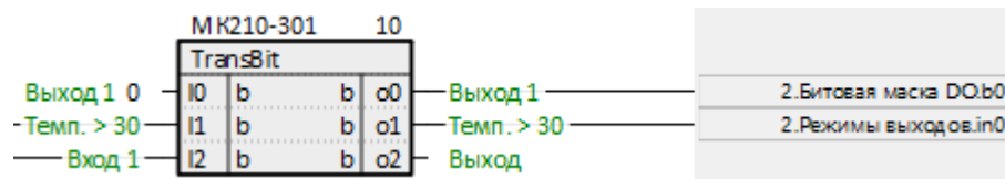
Рисунок 18 – Соединение блоков (Значения с модулей)
